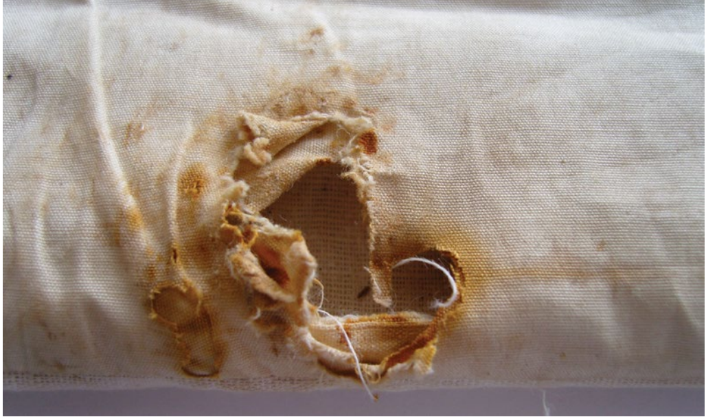
Fig. 3.8: Tecido degradado por oxidação 45 .
